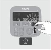
1- Drücken Sie auf die Auswahl-taste der Einstellung, die Sie ändern möchten: den Geschwindigkeitsregler (B1) oder den Gartemperaturregler (B2) oder den Zeitregler (B3). Daraufhin blinkt der ausgewählte Parameter auf der Anzeige auf (C5- C6-C7).
